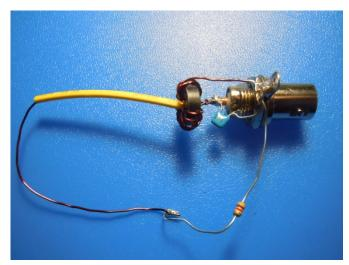
インピーダンス変換がしっかり行われているかを確認するため、負荷として  $4k7\Omega$ の抵抗を付けて測定しました。
