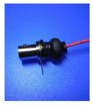
全体を熱収縮チューブで覆って一体化します。エレメントへの部分には何重にもチューブを重ねてコイルを覆ったチューブと一体化するように熱収縮チューブで覆います。
